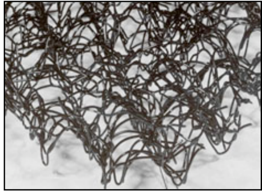
Figure 14 : Enkamat®, structure tridimensionnelle en polyamide
